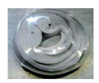
In einfacher Schutzfolie verpacktes vorkomprimiertes Band nach beschleunigter Lagerung / Institut OFI, Wien
