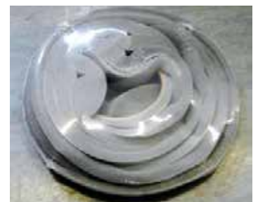
In einfacher Schutzfolie verpacktes vorkomprimiertes Band nach beschleunigter Lagerung / Institut OFI, Wien
